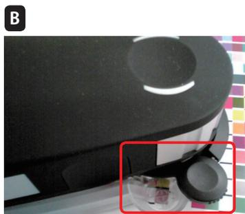
半透明のベースプレートの+印がパッチの真ん中に来ようセットしボタンを押して下さい。
