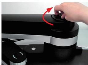
2) 白色パッチがついたプレートごと測色器が上に上がりますので、隙間に測色物を挿し込みます。次に高さ調節つまみを反時計回り方向に回し下げて下さい。測色ヘッドが測色物に触れない状態で極力近づけて下さい。
