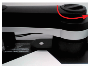
測色物を隙間に挿入し、つまみを反時計方向に回してプレートを下げる。
