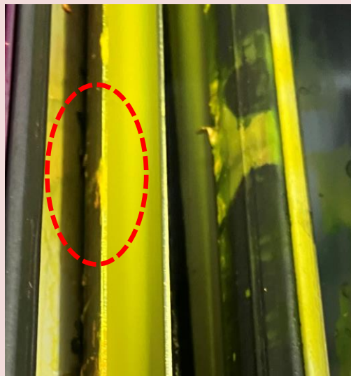
仕切り部分に堆積したインク
